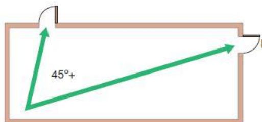
Figura nº 08: distância entre aberturas de saídas de emergência
