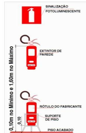
Figura 3: Detalhe de fixação e sinalização do extintor
