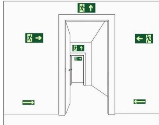
**Figura 5:** Exemplo de instalação de placas de sinalização acima da porta e na parede (ref. NBR 13434-2).
