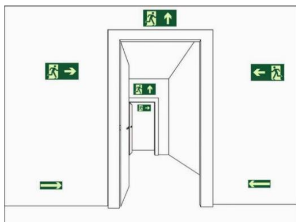
Figura 02: exemplo de instalação de placas de sinalização acima da porta e na parede
