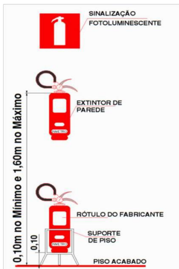
Figura 01: Detalhe da altura de instalação do extintor e placa de sinalização de equipamento
