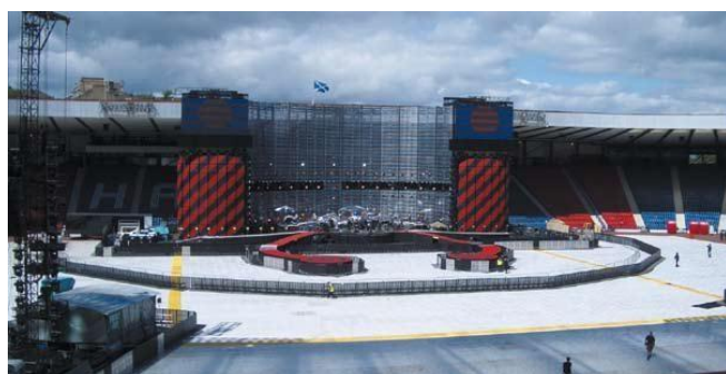
Figura nº 05: Setorização com barreiras antiesmagamento próximas ao palco
