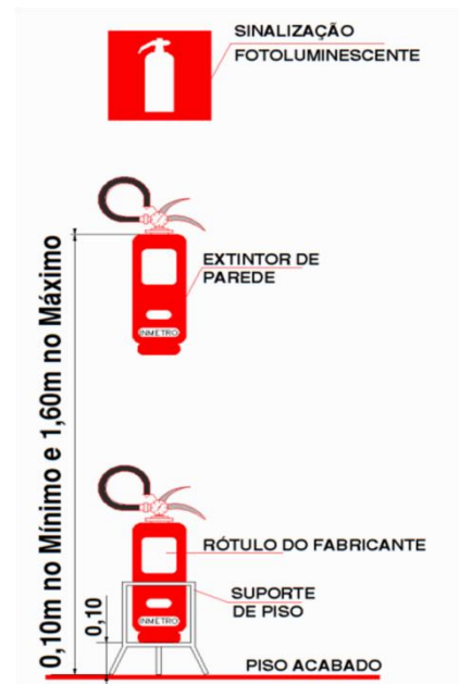
FIGURA 3: DETALHE DE FIXAÇÃO E SINALIZAÇÃO DO EXTINTOR
