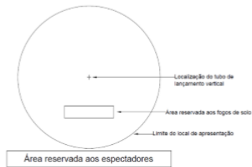
FIGURA 1 – Local da apresentação para tubo de lançamento na posição vertical
